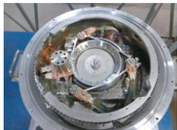
**WFOS** は可視光の天体画像とスペクトルを取得する機能を持っている装置で、宇宙空間における銀河間ガスの大規模構造解明などの成果が期待されています。アメリカ・中国・インドとともに開発が進められていて、先端技術センターではマスク交換機構の設計や面分光ユニットを組み込むアップグレード計画の検討を行っています。
