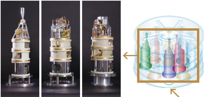
先端技術センターで開発したアルマ望遠鏡搭載受信機
