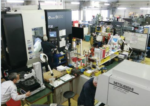
製造グループでは望遠鏡に搭載される観測機器の主要部品や実験装置の機械系部品の加工、測定等を行っています。その範囲は詳細な設計図に基づく製作から、依頼元のイメージを形にするにも対応しています。また、新たな技術として、金属3Dプリンターを用いた付加製造にも取り組み、切削加工と共に最先端の機器開発を支援しています。
