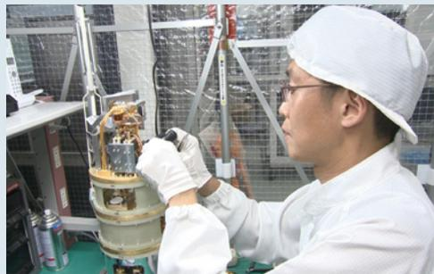
天文観測機器全体を組み立てて、運用環境や曝される環境を模擬して、要求されている性能を試験により確かめます。打ち上げ時や地震などの激しい振動環境への耐性試験、観測機器を運用する低温・真空環境などでの動作・制御試験を実施します。物質や粉塵などが付着しないように、大型クリーンルームや大型真空容器などに観測機器を格納して試験を実施することもあります。
