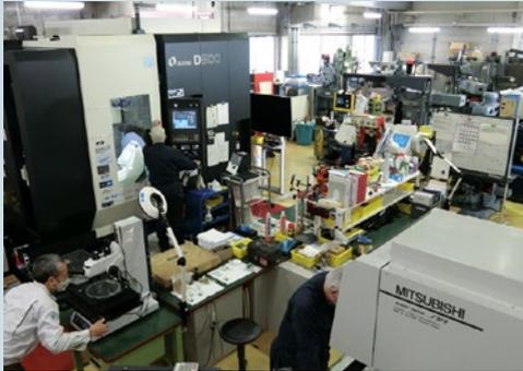
製造グループでは望遠鏡に搭載される観測機器の主要部品や実験装置の機械系部品の加工、測定等を行っています。その範囲は詳細な設計図に基づく製作から、依頼元のイメージを形にすることにも対応しています。また、新たな技術として、金属3Dプリンターを用いた付加製造にも取り組み、切削加工と共に最先端の機器開発を支援しています。
